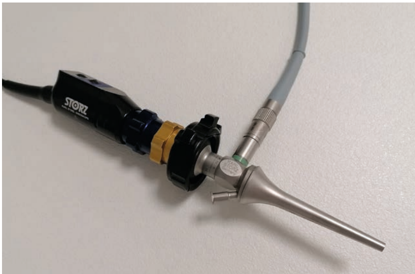
Abb. 6: Aufsatz für die Videootoskopie.
