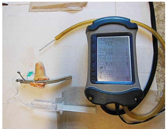
Vorrichtung zur Messung des Zitzendrucks beim Laufenlassen der Milch.
