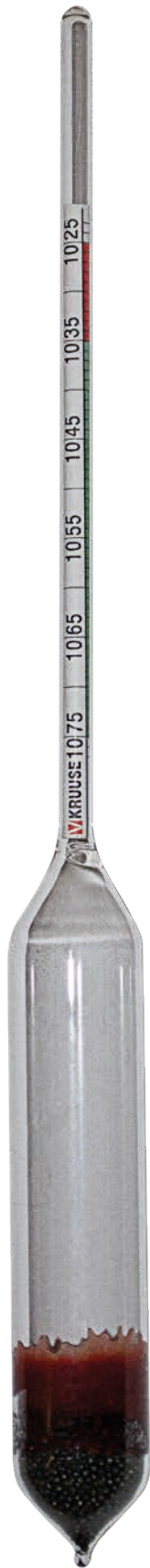
BILD 3: Eine zum Kolostrometer adaptierte Senkspindel.
