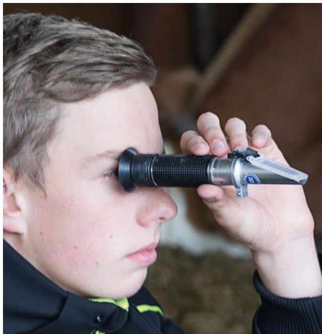
BILD 5: Refraktometer misst den Brechungsindex, dieser korreliert mit der Kolostrumqualität.
