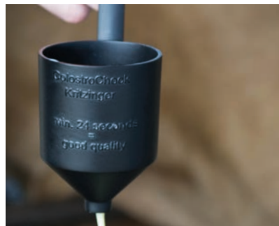
BILD 6: Präzisions-durchlauftrichter – ab einer Durchlaufzeit von 24 Sekunden handelt es sich um gute Kolostrumqualität.
